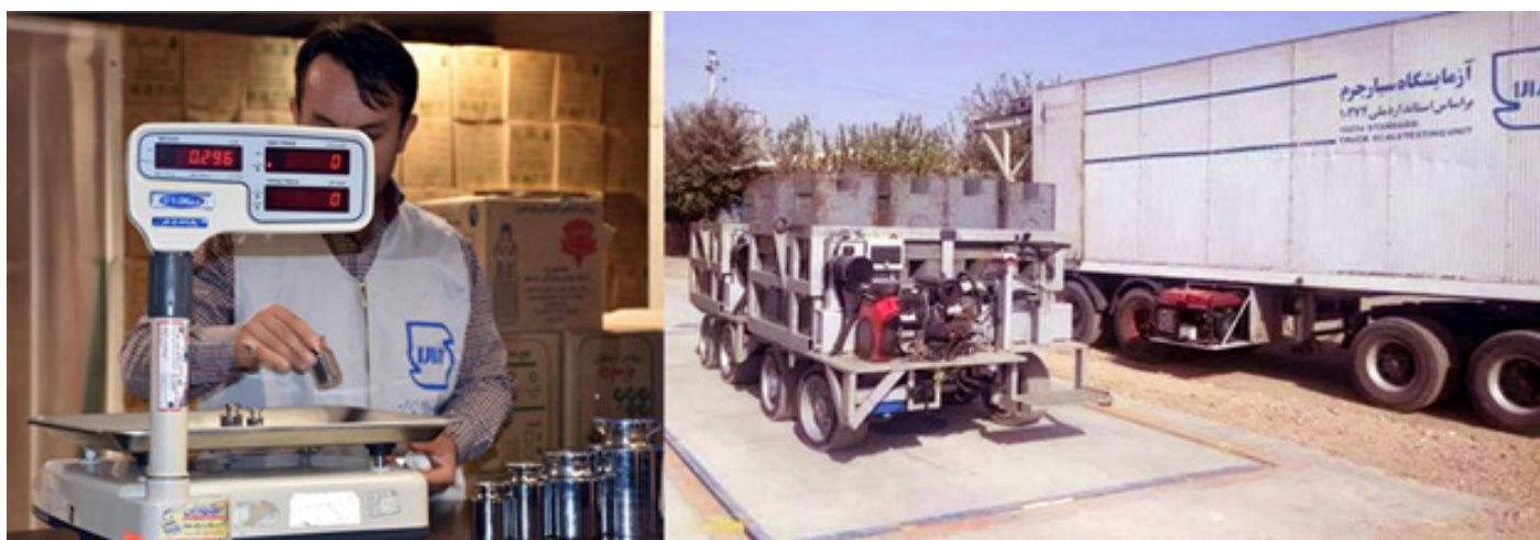
تصویر سمت راست: آزمون باسکول جاده‌ای توسط آزمایشگاه سيار بر اساس استاندارد ملی ۱۰۲۷۴ تصویر سمت چپ: آزمون ترازوی فروشگاهی توسط آزمایشگاه همکار استاندارد بر اساس استاندارد ۶۵۸۹
